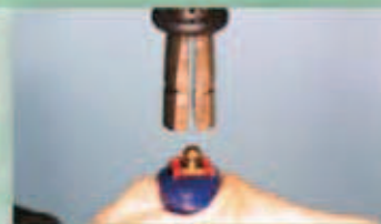
La sphère ayant été posée de façon parallèle avec un mandrin, veuillez ajuster la cire uniquement sur les trois pans
