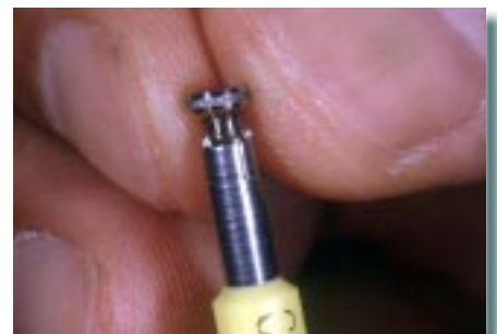
27. Le bouton-pression doit être vissé complètement jusqu'en butée avec la clef de laboratoire RE H 5.
