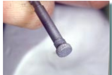
24. ...sont utilisés pour permettre un sablage plus aisé (meilleure adhérence du collage).
