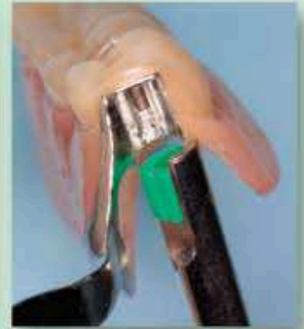
4 avec l'outil d'insertion, enfoncer le nouveau cavalier (régular ou court)
