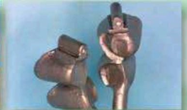
Sabler la partie coulée de telle sorte qu'il n'y ait aucune trace de céramique. Utiliser une fraise douce ou un acide
