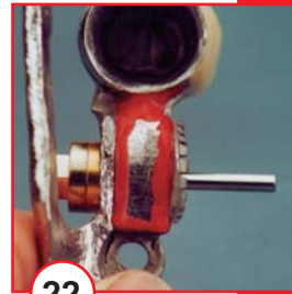
22 Comblar la base avec de la cire
