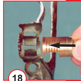
18 Remettre la partie secondaire en place
