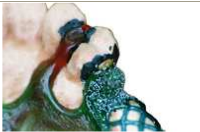
28. Remplir les puits de cire et les relier à la maquette par une potence puis saupoudrer de billes plastique les boitiers en cire
