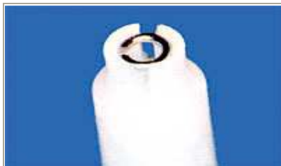
7. Introduire le segment métal dans la clé de montage
