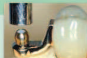
Fixer la sphère titanium avec un ciment anaérobique en utilisant le mandrin de l'OT CAP
